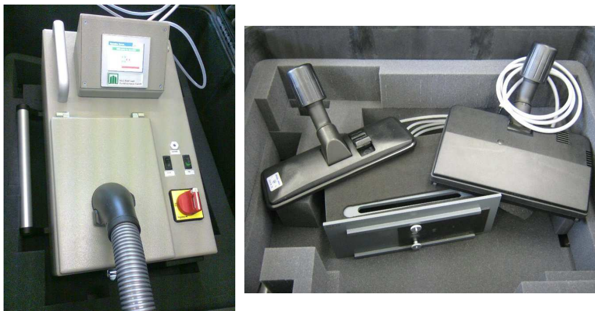
Figure D.1 – RSB doté d'un suceur passif et actif et d'une enceinte d'essai d'étalonnage sous vide
